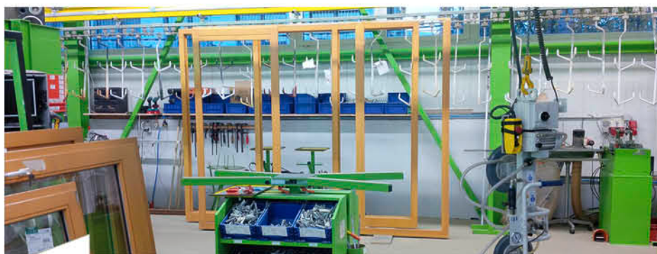
Beispiel Holzfertigung: Eine gut organisierte Logistik vermeidet bzw. reduziert unnötige Unterbrechungen im Fertigungsablauf und trägt dadurch auch bei Grünbeck entscheidend zur Steigerung der Produktivität bei. Dabei sorgt das im Rahmen des „Roto Lean“-Projektes eingesetzte Kanban-System für einen reibungslosen Materialfluss.
