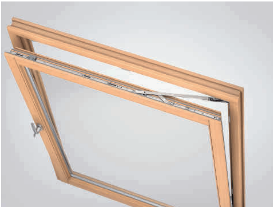
Modulares Baukastensystem: Die drei Axergrößen der vollverdeckten Bandseite „Roto NX | C“ werden bei allen Flügelmaßen immer auf dieselbe Weise standardisiert mittels Clip montiert.
