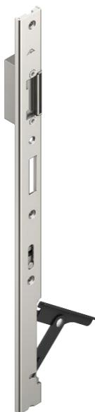
Palanca lateral en la cremona con palanca estándar: el mecanismo de falsa maniobra no bloquea la primera hoja de apertura hasta que la palanca esté retraída y el cerrojo principal bloquee el vástago. De este modo, asegura que se mantenga la secuencia de cierre correcta y que la puerta quede cerrada de forma segura.
